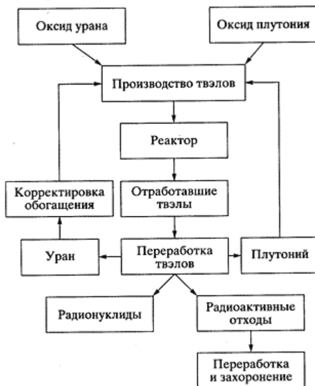
Рис.1.Схема производства и «сжигания» МОХ-топлива в бридерах.
