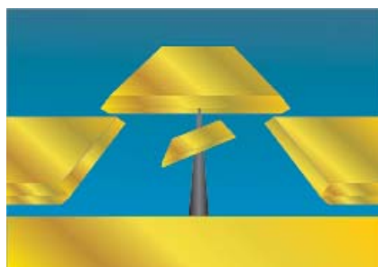
Рис 132. Наномотор на основе золотых электродов и нанотрубок
