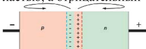
Рис 95. Схема обратного включения р-n перехода
