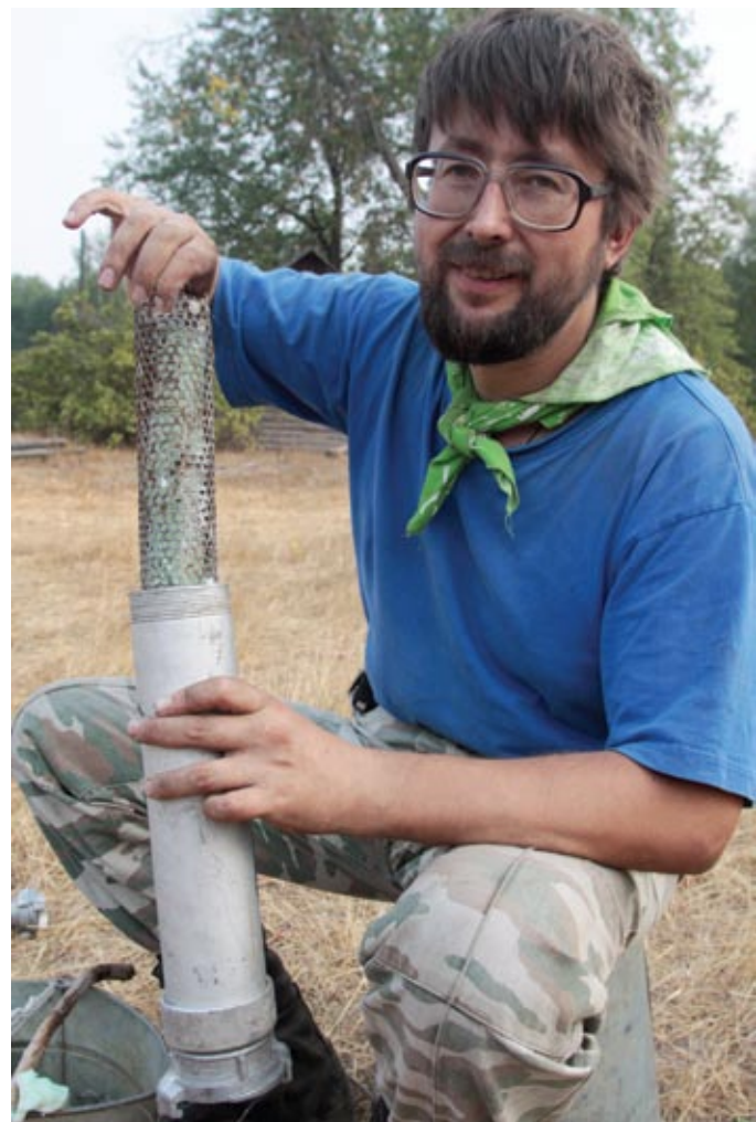
Использование специального смесителя для добавления смачивателя
