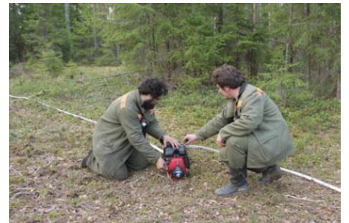
Последовательная установка мотопомп «в линию» при подаче воды на большое расстояние
