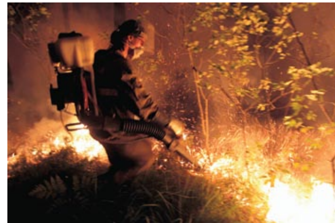
Применение воздуходувки на тушении лесного пожара
